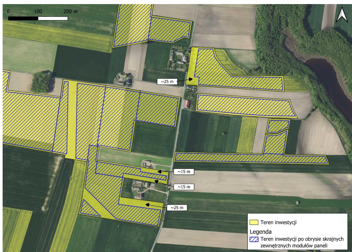
Rysunek 1 Miejsca odsunięcia obszaru posadowienia panelami
