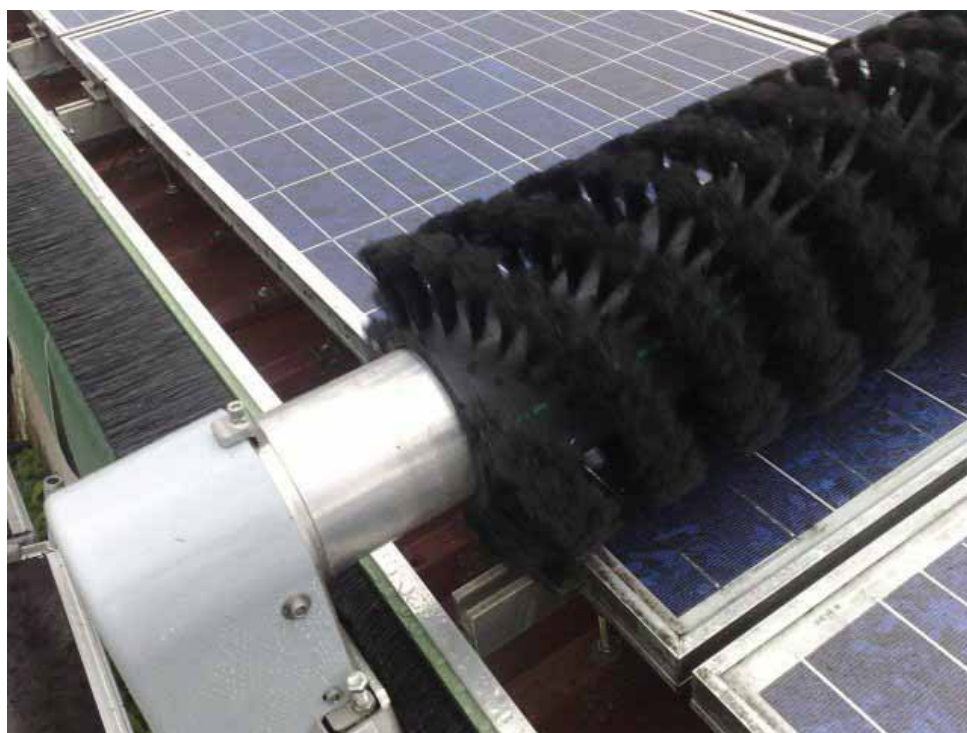
Fotografia 3 Bezwodna technologia czyszczenia paneli fotowoltaicznych
