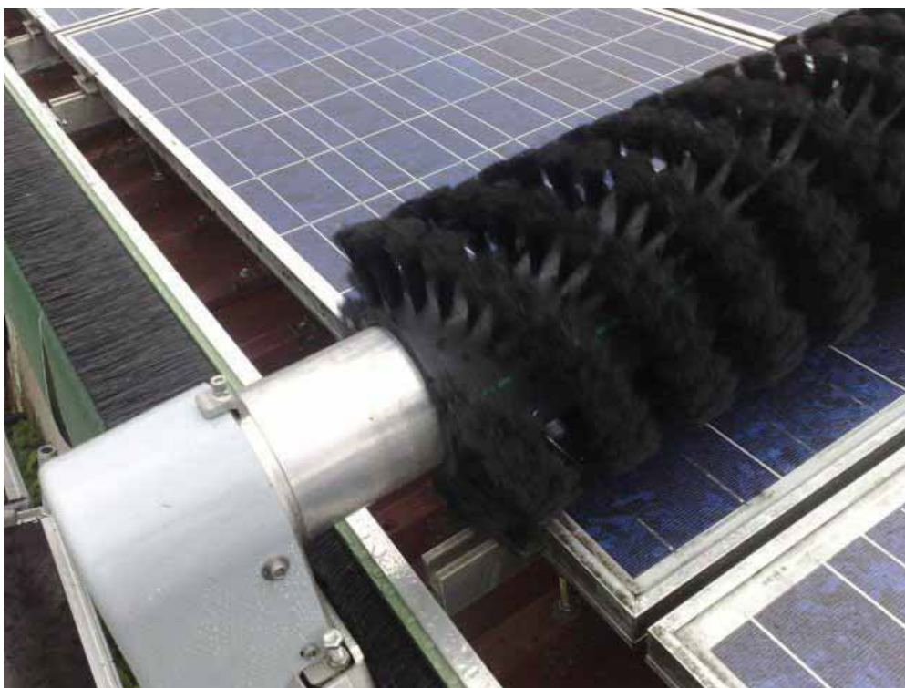
Fotografia 3 Bezwodna technologia czyszczenia paneli fotowoltaicznych
